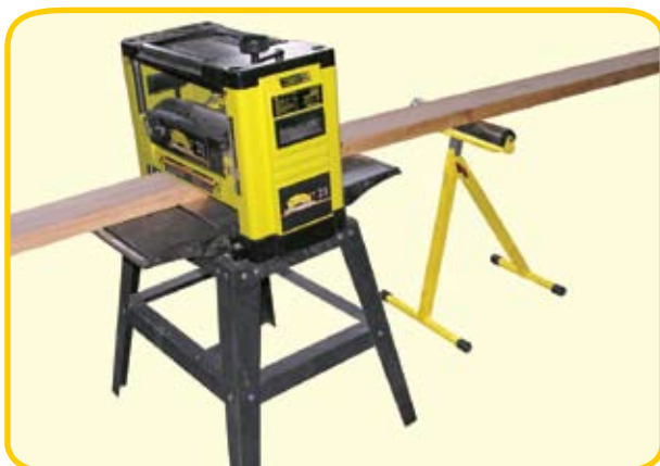
Пример использования роликовой опоры с рейсмусовым станком
