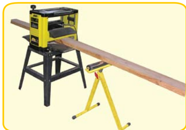
Пример использования роликовой опоры с рейсмусовым станком
